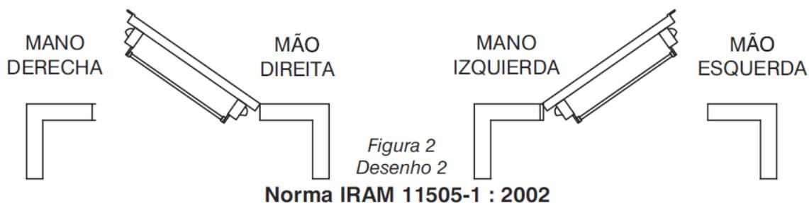
Figura 13 – Determinação do sentido de abertura da porta.
