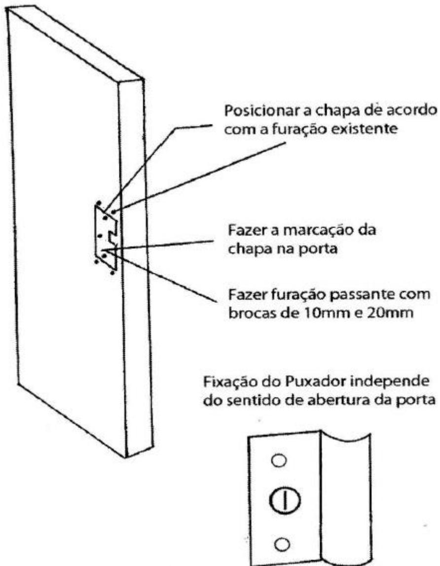
Figura 23 – Instalação do Puxador.
