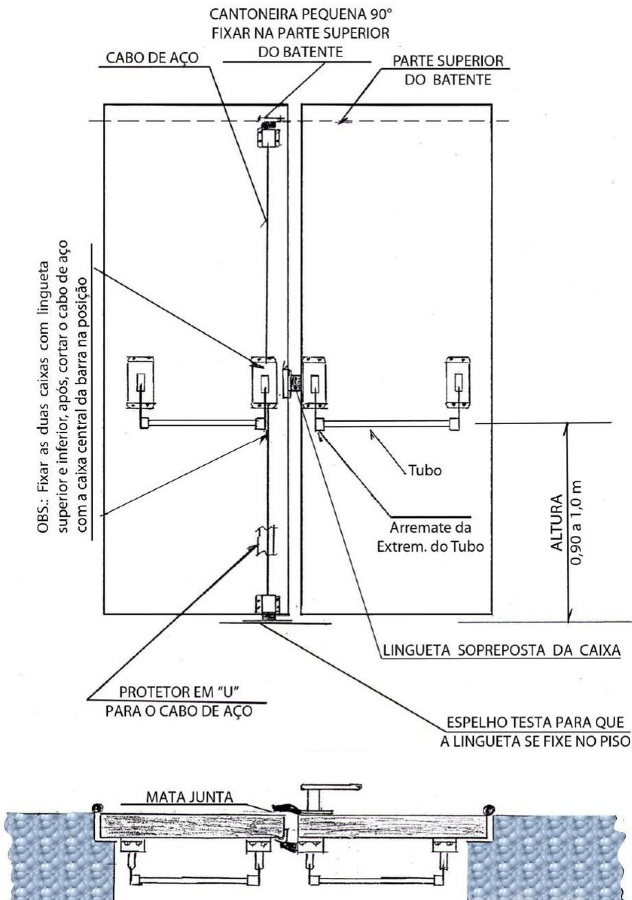
Figura 22 – Instalação da Barra Anti-pânico Dupla
