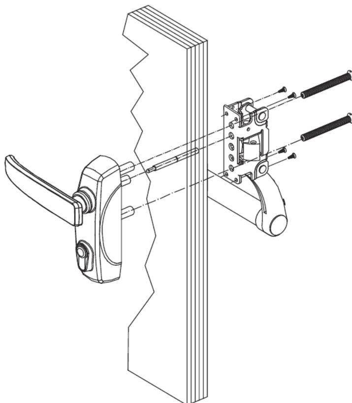
Figura 18 – Encaixe do conjunto fechadura-mecanismo.
