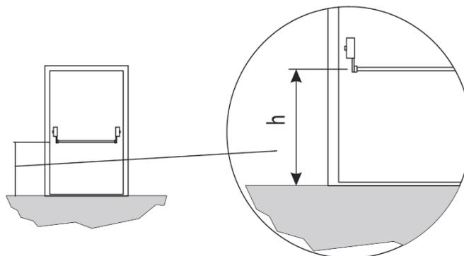
Figura 15 – altura de colocação do mecanismo.
