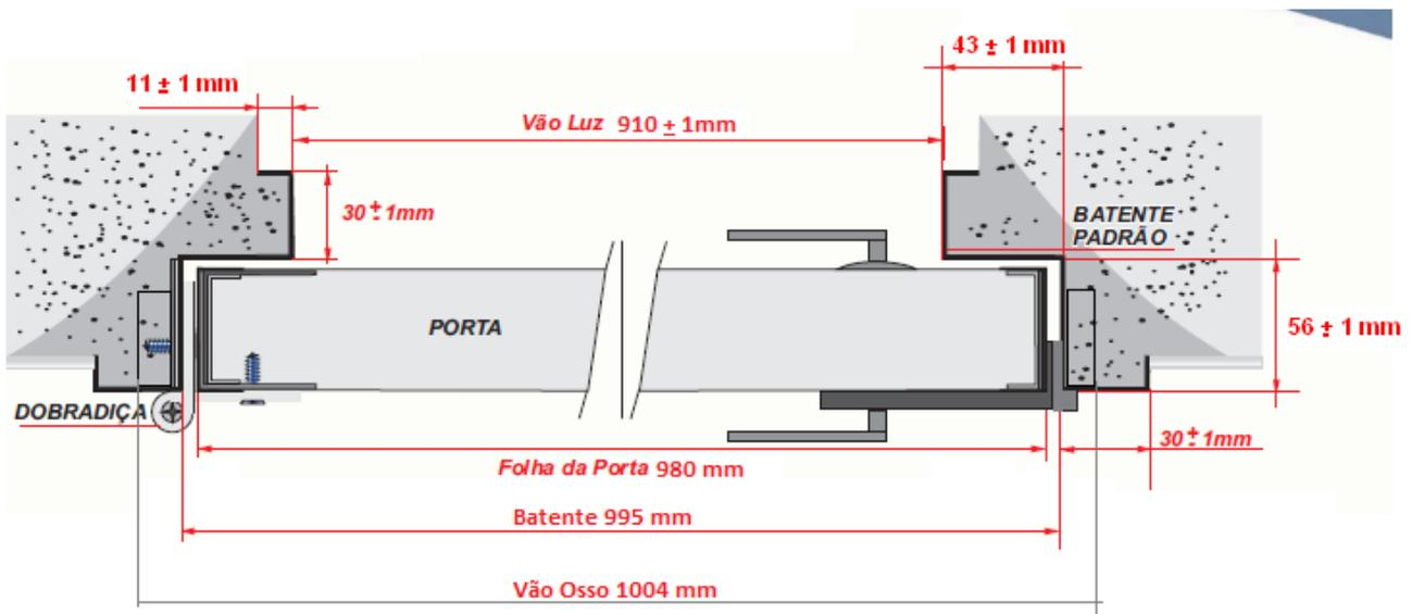
Figura 10 – Detalhe do batente e da porta (98 cm) instalada na alvenaria.
